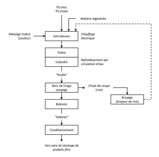
La matière première est généralement un mélange de polystyrène choc et de polystyrène cristal. Une partie de la matière est constituée de matière régénérée.
